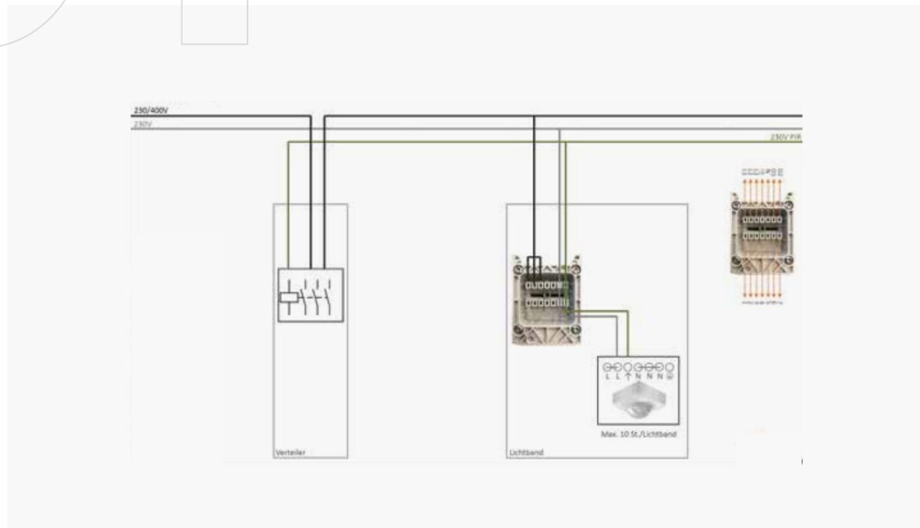
Systemlösung mittels geschalteten Lichtbändern. Hier ein Sensor mit Schaltausgang.
